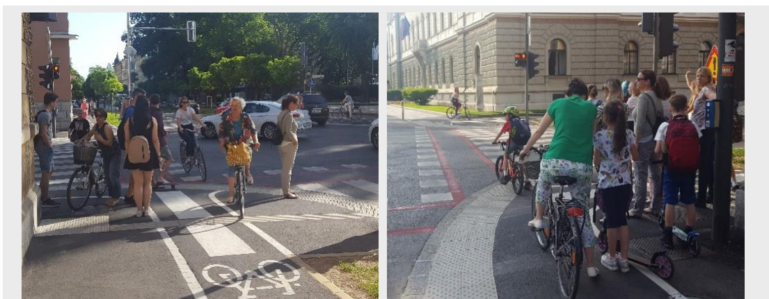
Sliki 2 (neustrezno): Križišče, kjer je ob prometnih konicah opaziti neuporabnost talnih označb, ki ločujejo pešce od kolesarjev. Te so sicer izvedene v skladu s Pravilnikom o kolesarskih površinah z upoštevanjem minimalno določenih dimenzij. Pešci stojijo na kolesarskem pasu, kolesarji vozijo med njimi. Na takšnih mestih je zelo pomembno, da se nedvoumno predvidi uredi odvzem prednosti kolesarjem, ki morajo tako svojo hitrost in pot prilagoditi pešcem.
