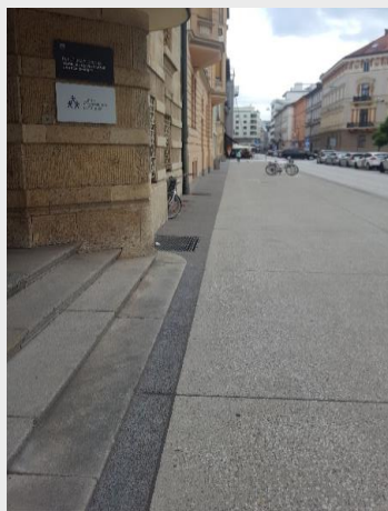
Slike 41 (ustrezno): Primer ureditev, kjer je vizualni kontrast v tlaku uporabljen tako, da izboljša orientacijo in olajša hojo slabovidnim. 1. in 2. Svetli tlak je namenjen pešcem. Temni robni pas označuje površino, ki je neprimerna za hojo, saj se v njegovem območju nahajajo ovire (stopnice, koši, izbočeni oboki vhodov). Če hodimo po svetlem tlaku ob temnem robu, lahko varno pridemo mimo ovir. 3. Temna pot označuje prehod brez ovir mimo gostinskih vrtov in drugih ovir, ki stojijo na svetli površini. Poleg tega, da takšen kontrast zelo pomaga slabovidnim, da najdejo pot čez trg, daje tudi izrazit signal gostincem in gostom, da ne postavljajo ovir na glavno dostopno pot.
