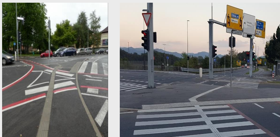
Slika 11: 1. (neustrezno): Primer neustrezne ureditve na cestnem otoku, kjer je talnih označb preveč in zato zelo zmedejo uporabnika. Preveč talnih označb zelo slabo vpliva na varnost najranljivejših skupin (otroci, starejši, ljudje z motnjo v duševnem razvoju, slabovidni...), saj zaradi preveč barv in vzorcev mnogi ljudje izgubijo orientacijo in težko ločijo, kje je varna površina za pešce. 2. (ustrezno): Primer označb na otoku, ki dajejo ključne informacije tako v taktilni kot v vizualni obliki: poudarjen rob ceste (nevarnost), glavna smer prehoda čez cesto za pešce.
