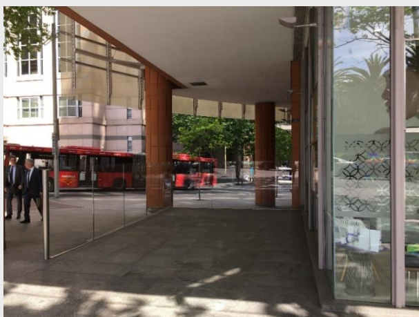
Slike 40 (neustrezno): 1. Steklena ograja, ki jo uporabnik z okvaro vida ne more opaziti. 2. Pri izboru tlakov se izogibamo bleščečim, močno odsevnim tlakom, ki zelo poslabšajo vidno zaznavo.
