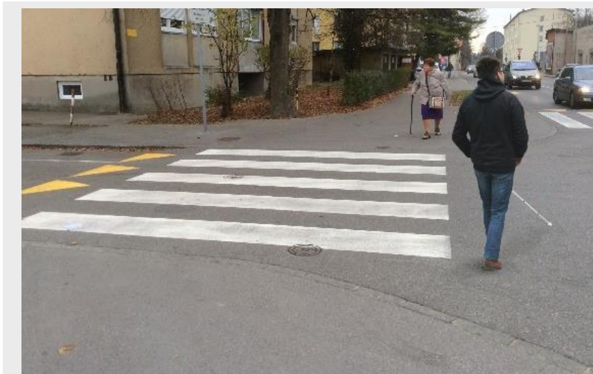
Slika 12 (neustrezno): Prehod za pešce na trapezni ploščadi, ki je zelo priporočljiv za izboljšanje prehodnosti za pešce, vendar je pomanjkljivo opremljen z vidika slepih in slabovidnih. Ker manjkajo taktilne oznake, ki označujejo rob peščeve površine, ljudje z okvarami vida lahko zaidejo na cesto.
