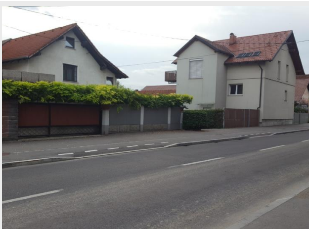
Sliki 33 (ustrezno): Primer ureditve dovozov v območju robnika. Peščeva površina je ravna, kar je pomembno predvsem za uporabnike invalidskih vozičkov, strmi uvozi so dovolj zaznavni tudi za ljudi z okvarami vida, da ne zaidejo na cesto.
