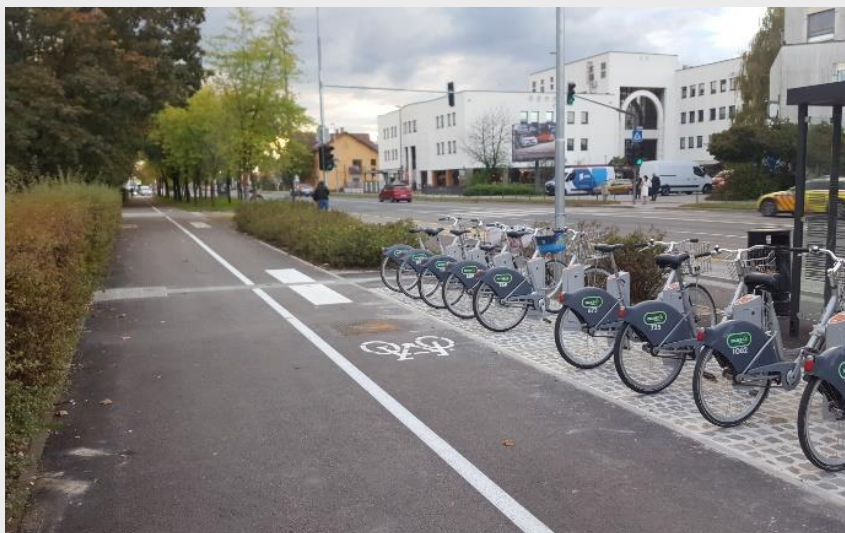
Slika 14: Ustrezno umeščeni prostori za izposajo koles izven območja pločnika. Prostor za parkiranje koles je ustrezno označen s taktilno zaznavnim tlakom.
