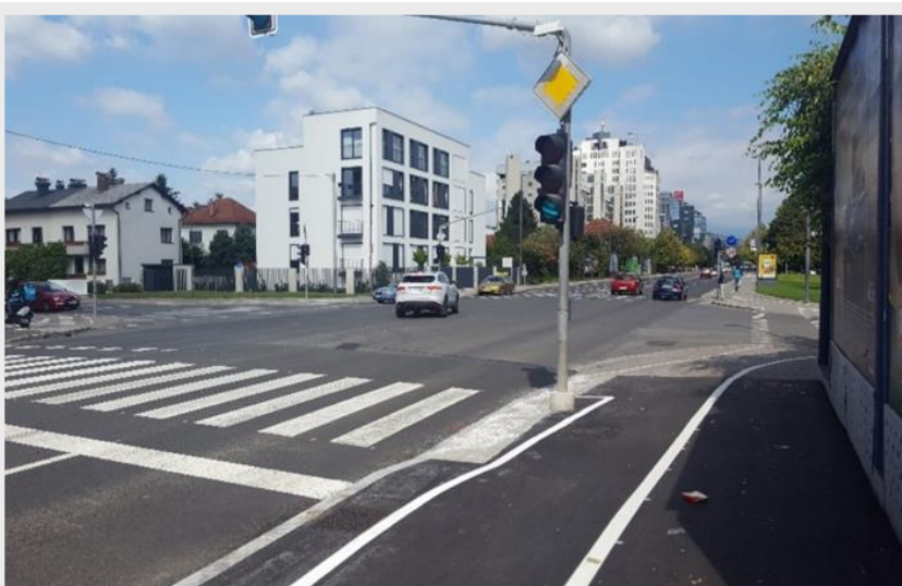
Slika 7 (neustrezno): Primer premajhne površine za čakanje pešcev na prehodu za pešce. Pešci, ki čakajo prehodu za pešce, ovirajo pot kolesarjev. Pogosto pešci zato čakajo pred kolesarskim pasom, kar pomeni, da se pot čez cesto podaljša. Ob cesti je treba omogočiti dovolj široko površino za čakanje uporabnika na invalidskem vozičku, brez da s tem posega na kolesarsko stezo.
