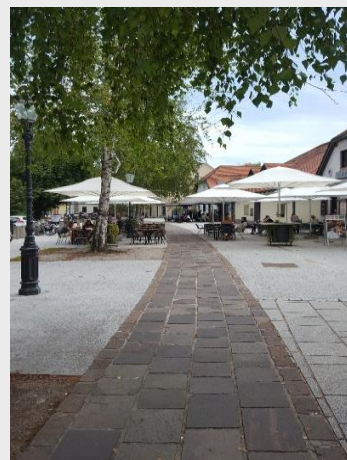
Slike 41 (ustrezno): Primer ureditev, kjer je vizualni kontrast v tlaku uporabljen tako, da izboljša orientacijo in olajša hojo slabovidnim. 1. in 2. Svetli tlak je namenjen pešcem. Temni robni pas označuje površino, ki je neprimerna za hojo, saj se v njegovem območju nahajajo ovire (stopnice, koši, izbočeni oboki vhodov). Če hodimo po svetlem tlaku ob temnem robu, lahko varno pridemo mimo ovir. 3. Temna pot označuje prehod brez ovir mimo gostinskih vrtov in drugih ovir, ki stojijo na svetli površini. Poleg tega, da takšen kontrast zelo pomaga slabovidnim, da najdejo pot čez trg, daje tudi izrazit signal gostincem in gostom, da ne postavljajo ovir na glavno dostopno pot.
