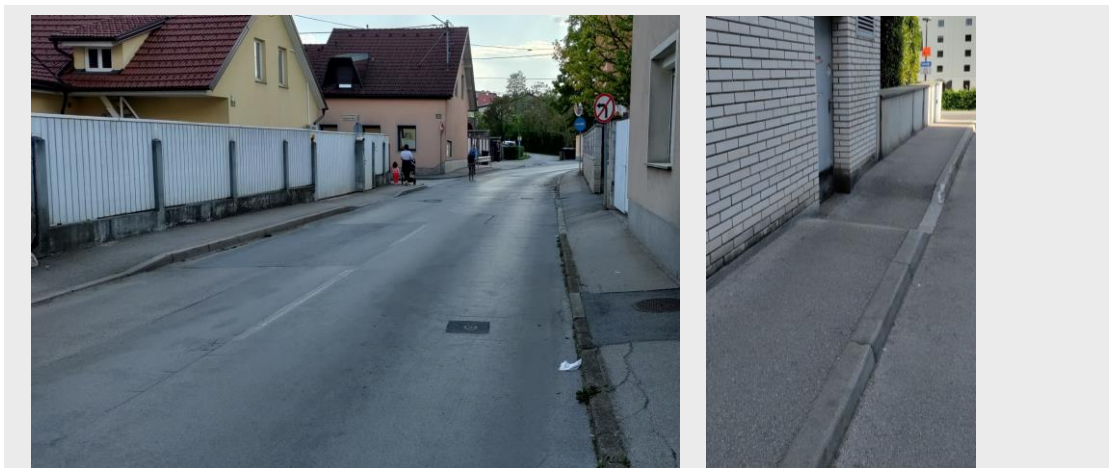
Sliki 28 (neustrezno): Prehod z vozičkom na pločnikih zelo otežuje tudi prestrm prečni naklon pločnika in uvozi, ki prekinjajo pločnik s strmimi klančinami.
