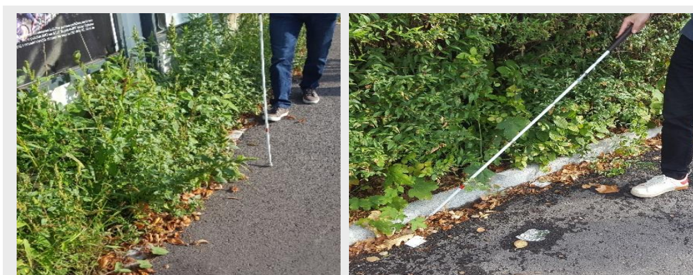
Sliki 20: Oteženo gibanje ob robu zaradi slabo vzdrževane zelene površine. 1. Zaradi slabo vzdrževane zelenice se bela palica zatika in zelo otežuje hojo. 2. Navkljub slabo vzdrževani drevnini je zaradi dvignjenega robnika sledenje robu preprostejše.
