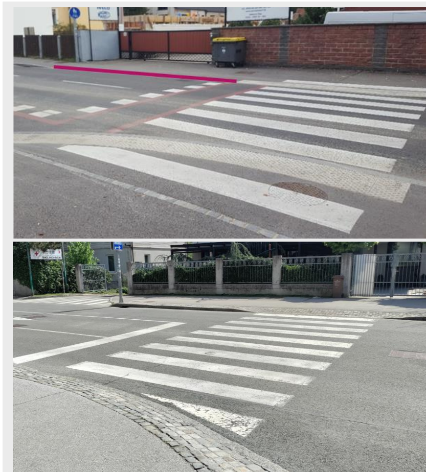
Sliki 32: 1. (neustrezno): Primer težavne situacije, kjer je dovoz postavljen neposredno ob znižanju prehoda za pešce in ni označen s čepastimi oznakami. 2. Primerna uporaba granitnih kock za označitev roba pločnika, posebej dobrodošla v primerih, kjer pogosti dovozi prekinjajo pločnik.
