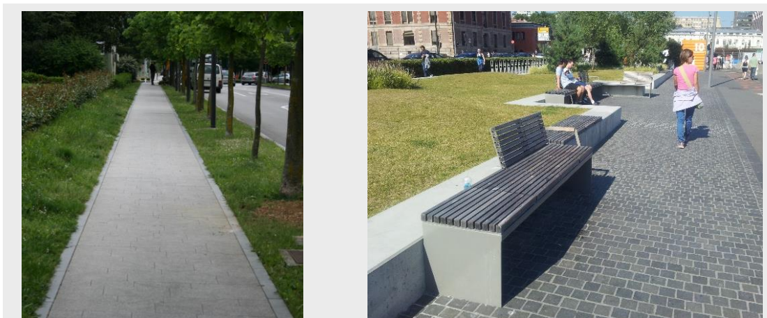
Sliki 18: 1. Primer nečlenjenega roba pločnika (ustrezen rob) 2. Primer zelo členjenega roba, ki ni primeren za orientacijo ljudi z okvarami vida.
